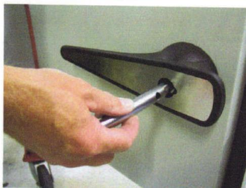
Remonter la poignée intérieure et revisser manuellement la vis six pans l'aide d'une clef à pipe de 13. Deux des bords plats du boulons doivent être parallèle à la poignée ( fig.21 )
