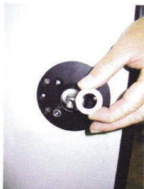
Si la poignée tourne difficilement, démonter la poignée intérieure et rajouter une rondelle de compensation.
